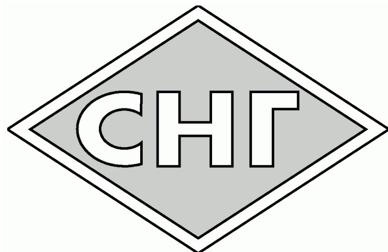
Рисунок 4.4 - Образец опознавательного знака КТС категорий М2 и М3, использующих в качестве топлива сжиженный нефтяной газ (СНГ) или компримированный природный газ (КПГ)
